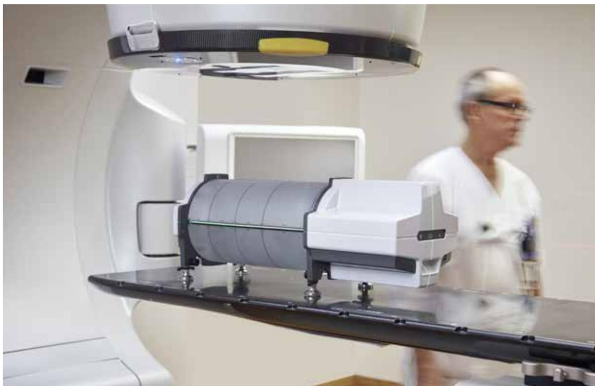
Le nouveau fantôme sans fil Delta<sup>4</sup> Phantom+ permet une vérification rapide et précise pour les techniques de traitement modernes.
